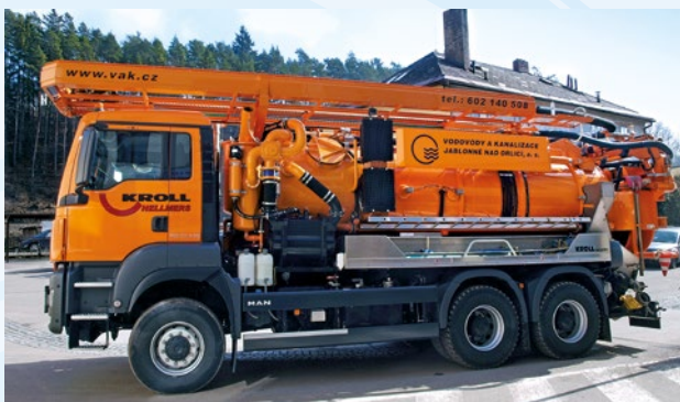
Speciální vysokotlaký čisticí vůz na čištění kanalizace Kroll-Hellmers
