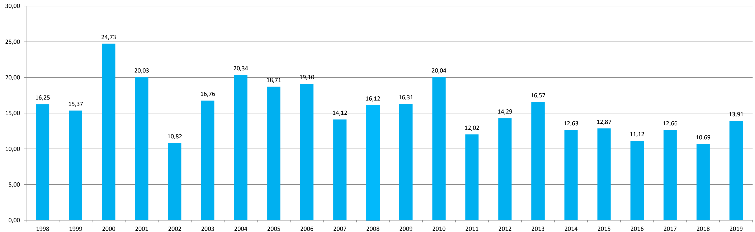
Ztráty ve vodovodní síti v % - provoz vodovodů Jablonné nad Orlicí
