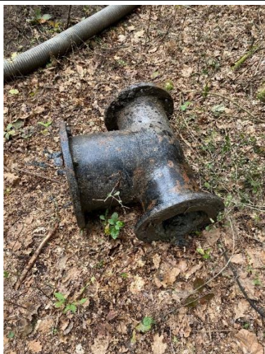
Odříznuté zhlaví vrtu
