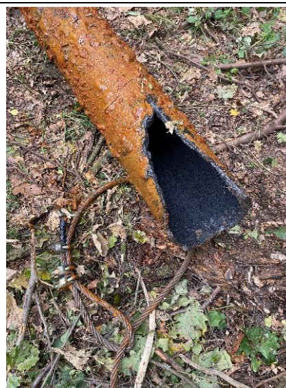
Porušená litinová pažnice ø 225 mm
