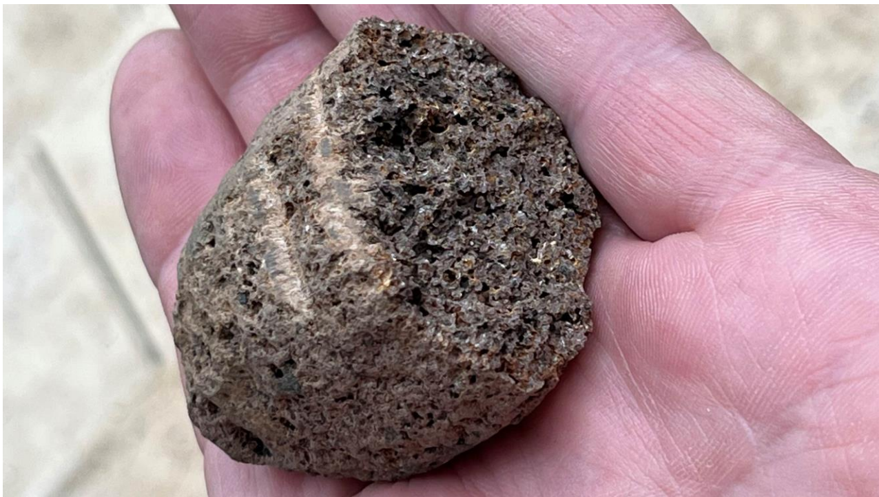
Obrázek č. 6 Silně porézní tefrit z vrtu HGP-2022
