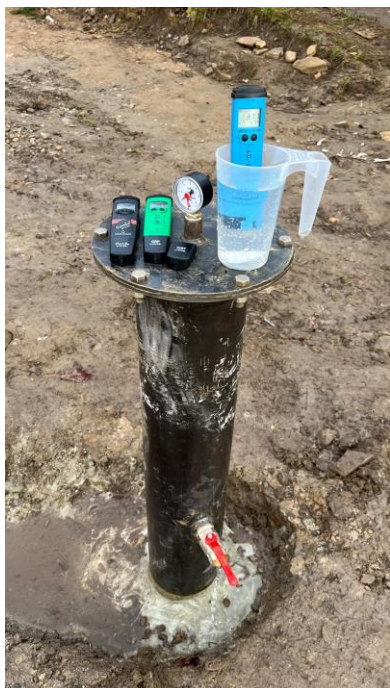
Obrázek č. 11: Terénní měření základních fyzikálních parametrů
